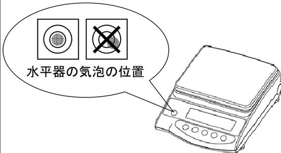
水平器の気泡が赤丸の中に入るように、アジャスタ(前後左右4ヶ所)を回しながら調整します。
