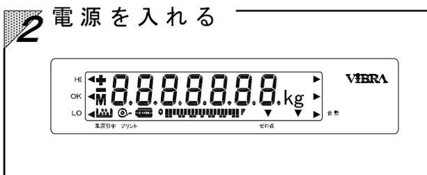
全表示の点灯中に表示部分の欠け、未点灯部分が無い事を確認してください。
