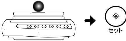
「\*」が表示されたら [セット] キーを押します。数秒間「Σ」と累計値が表示され、重量表示に戻ります。
