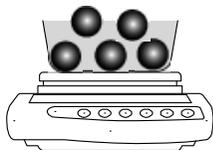
基準重量に対する計量物のパーセントが表示されます。
