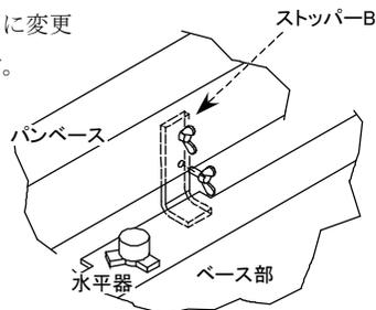
①ストップパーBをパンベースの外側から取り付け、ストップパーの先端をベース部の内側に潜らせます。
