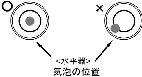
アジャスタで本体の傾きを調整します。水平器の気泡が円の内側に入るようにアジャスタを動かします。アジャスタは前後左右に4箇所あります。
