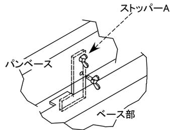
①ストップパーAをパンベースの外側から取り付け、ストップパーの先端をベース部の内側に潜らせます。
