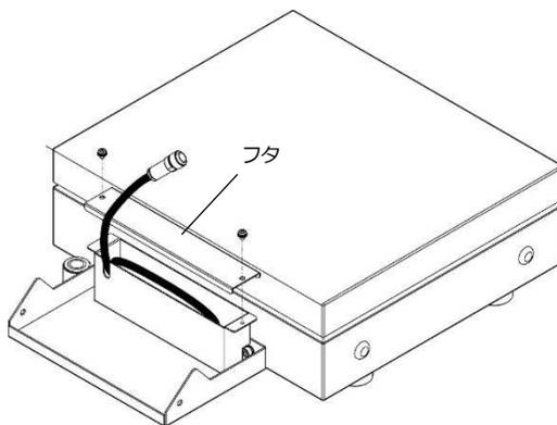
(1) 接続ケーブルを収納BOXの中に折りたたむように収納します。
