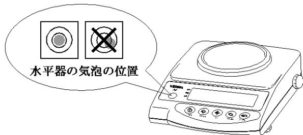
水平器の気泡が赤丸の中に入るように、アジャスターを回しながら調整します。
